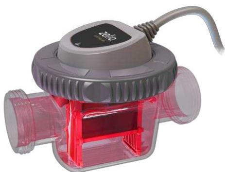
Élément essentiel de votre système, la cellule est équipée d'électrodes constituées de plaques pleines en titane traitées à l'oxyde de ruthénium. Elle est spécialement conçue pour offrir une durée de vie maximale et limiter les opérations de maintenance.
