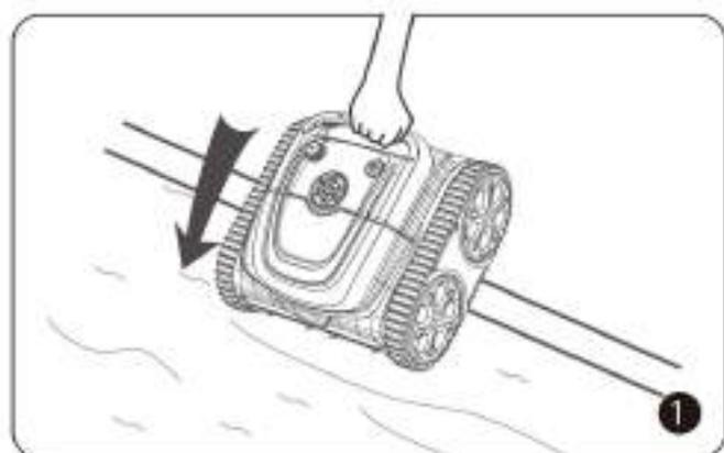
Mettez l'appareil en marche, tenez la poignée du nettoyeur et mettez-le verticalement dans la piscine.
