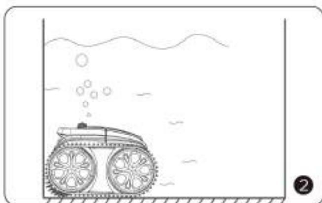
Laissez-le descendre jusqu'au sol pour vider l'air bloqué à l'intérieur.
